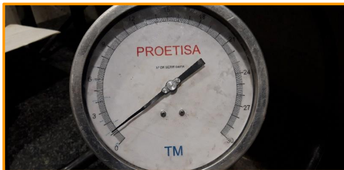
FUERZA DE EXTRACCIÓN ENSAYO 2
